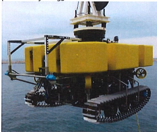
Photo 2 : Engin de water-jetting
