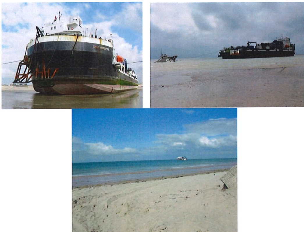
Photos 8 : navire posant un câble en zone « nearshore »
