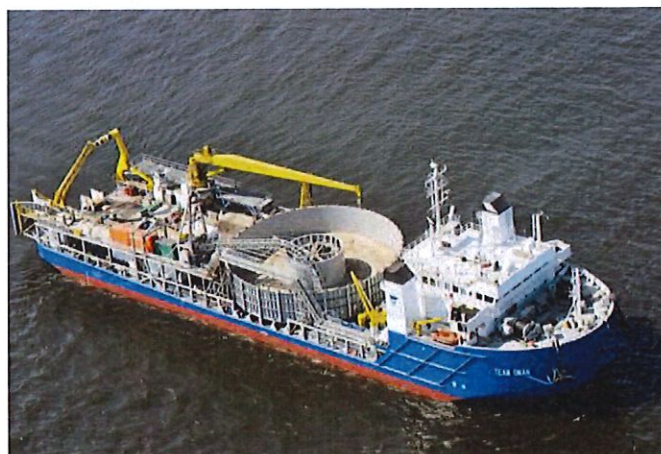
Photo 9 : navire posant des câbles
